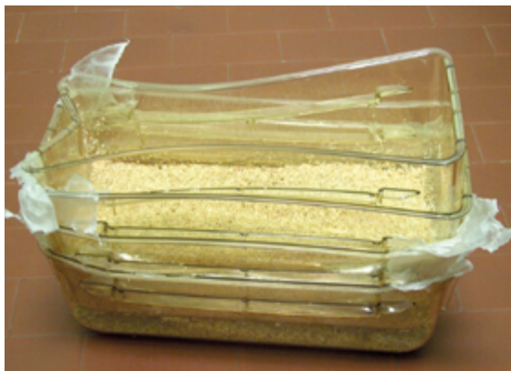
Abb. 9-6 links Verformung bei Käfigschalen, rechts Risse bei Käfigschalen
