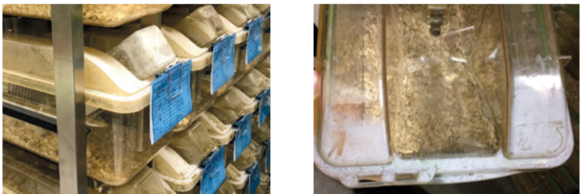
Abb. 9-2 links Käfighaube und Tränkeflasche aus Polysulfon mit milchig weiß aussehender Materialeintrübung, rechts Detailsicht Käfighaube
