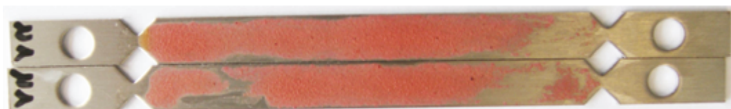
Abb. 7-6 Darstellung Prüfkörper bei verschiedenen Reinigungsergebnissen
