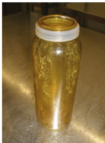
Abb. 7-8 Tränkeflasche mit unzureichendem Prüfungsergebnis
