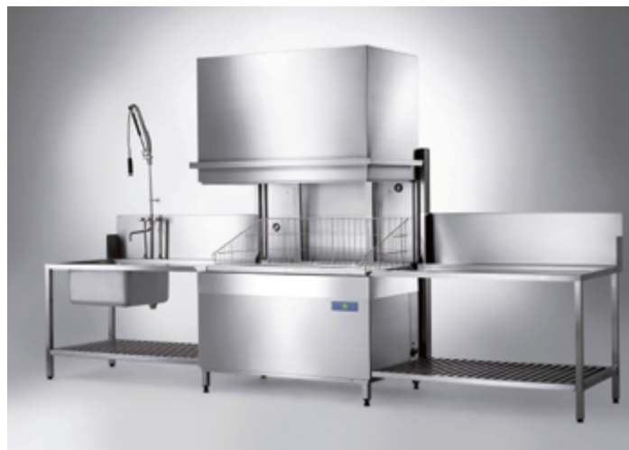
Abb. 4-9: Käfigkabinettreinigungsanlage mit Haube (ggf. Ergänzung von Zu- und Auslaftischen erforderlich)
