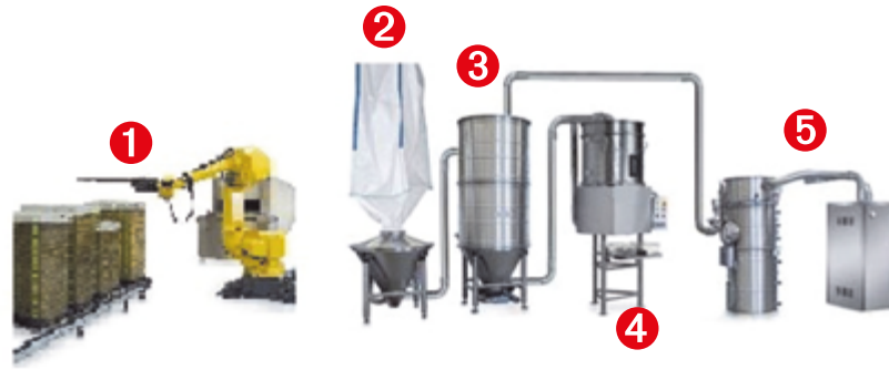
Abb. 4-18 Beispiel eines vollautomatischen Systems: Befüllung der Käfige mit Roboter oder Automaten ①, Befülltrichter saubere Einstreu z. B. mit BIG-Bag ②, optionales Lagersilo ③, Dosierspeicher mit Staubabsaug-einrichtung ④ und Vakuumerzeuger und Staubfilter ⑤ für die pneumatische Förderung.
