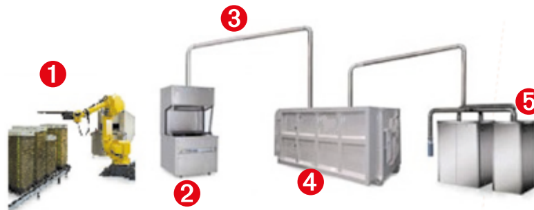
Abb. 4-7 Beispiel eines vollautomatischen Systems: Entleerung der Käfige durch Roboter oder Automaten ① in den Abwurftrichter ②, mit pneumatischer Förderung über Rohrleitung ③ in externes Behältnis ④; Vakuumerzeuger und Staubfilter ⑤
