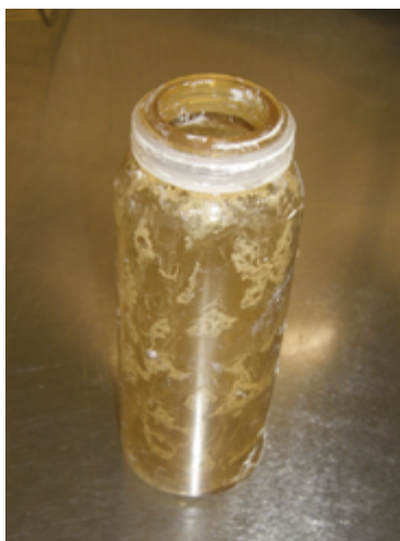
Abb. 7-7 Tränkeflasche mit Prüfanschmutzung
