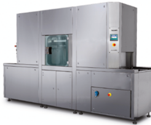
Abb. 4-14: Flaschenreinigungsanlage mit automatischer Entkappung, Förderung, Reinigung, Befüllung und Bekappung
