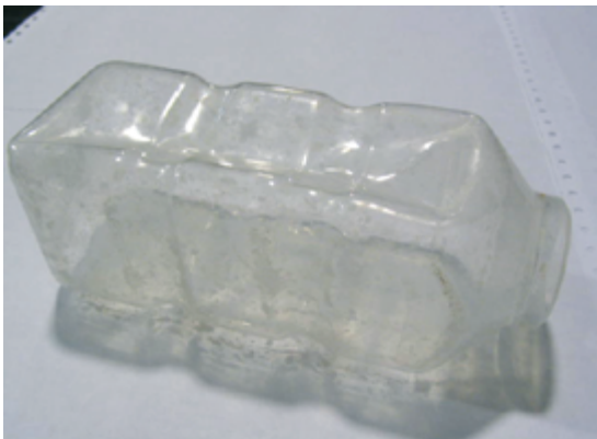
Abb. 9-5 Ansicht Tränkeflaschen mit Verformungen
