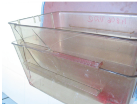
Abb. 9-6 links Verformung bei Käfigschalen, rechts Risse bei Käfigschalen
