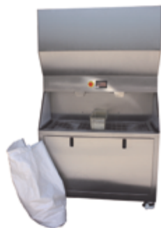
Abb. 4-16 Beispiel eines teilautomatischen Systems: Mobiler Dosierspeicher mit geeigneten Staubabsaug-einrichtungen
